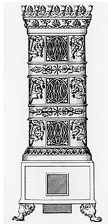
Bereits zu Beginn des 18. Jahrhunderts war der Eisenguss soweit entwickelt, dass breite und gleichmäßig starke gusseiserne Ringe hergestellt werden konnten. Hieraus entstanden die ersten Rundöfen aus drei bis vier Teile passgenau aufeinander gesetzten Teilen. Diese Öfen wurden bis Mitte des 19. Jahrhunderts gegossen.
